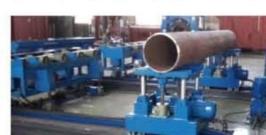
管道换向输送系统 Exchange system
