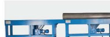
管道进料输送系统 Front pipe conveyer
